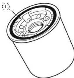
Рис. 51 Кольцо уплотнительное масляного фильтра
